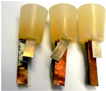
Unterschiedliche Korrosionsgrade an Teststreifen
